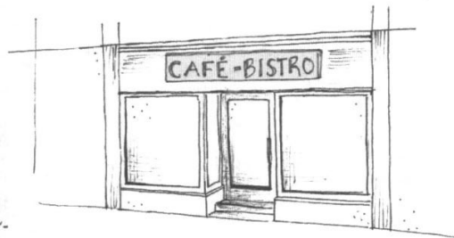
Enseigne posée à plat
